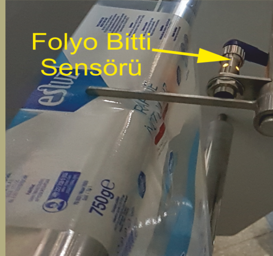
Folyo Bittiğini Algılar ve Makineyi Durdurur
