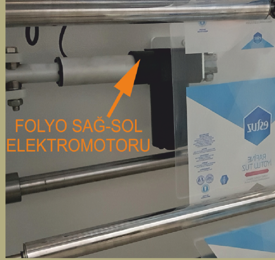
Elektromotorlu Bobin Standı Sağ-Sol Ayarı
